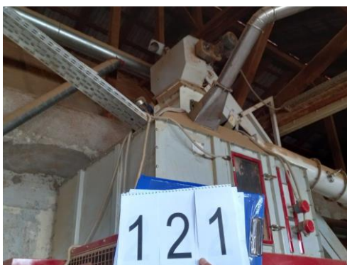
121-Dozator hladnjaka-pužni transporter
