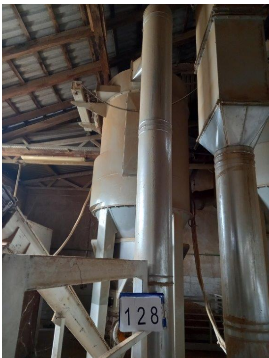
128-Cjevovod aspiracije, fi 300 mm
