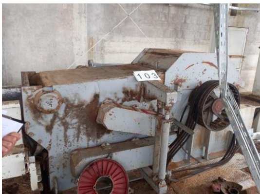
103- VECOPLAN SJEČKALICA + metalni detektor za sjeckanje pilanskog ostatka tvrdog drveta i višemetrice
